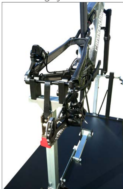
Sistema di bloccaggio rapido posteriore Rear quick locking system
